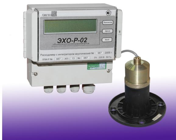
При измерении расхода в открытых каналах, акустический преобразователь устанавливается над лотком, а при измерении расхода в безнапорных трубопроводах, помещается в специальный звуковод и соединяется кабелем длиной до 200 м с электронным блоком, который устанавливается в отапливаемом помещении. По заказу, расходомер может быть адаптирован к кабелю длиной до 300 м. Тип кабеля – любой экранированный кабель с количеством жил не менее пяти.
