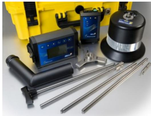
Система MIKRON™ улавливает шумы, являющиеся следствием утечки в подземных трубопроводах. Шум утечки передается через воду и стенки трубы и таким образом он может быть определен путем прослушивания на задвижках и гидрантах используя ручной датчик MIKRON™.
