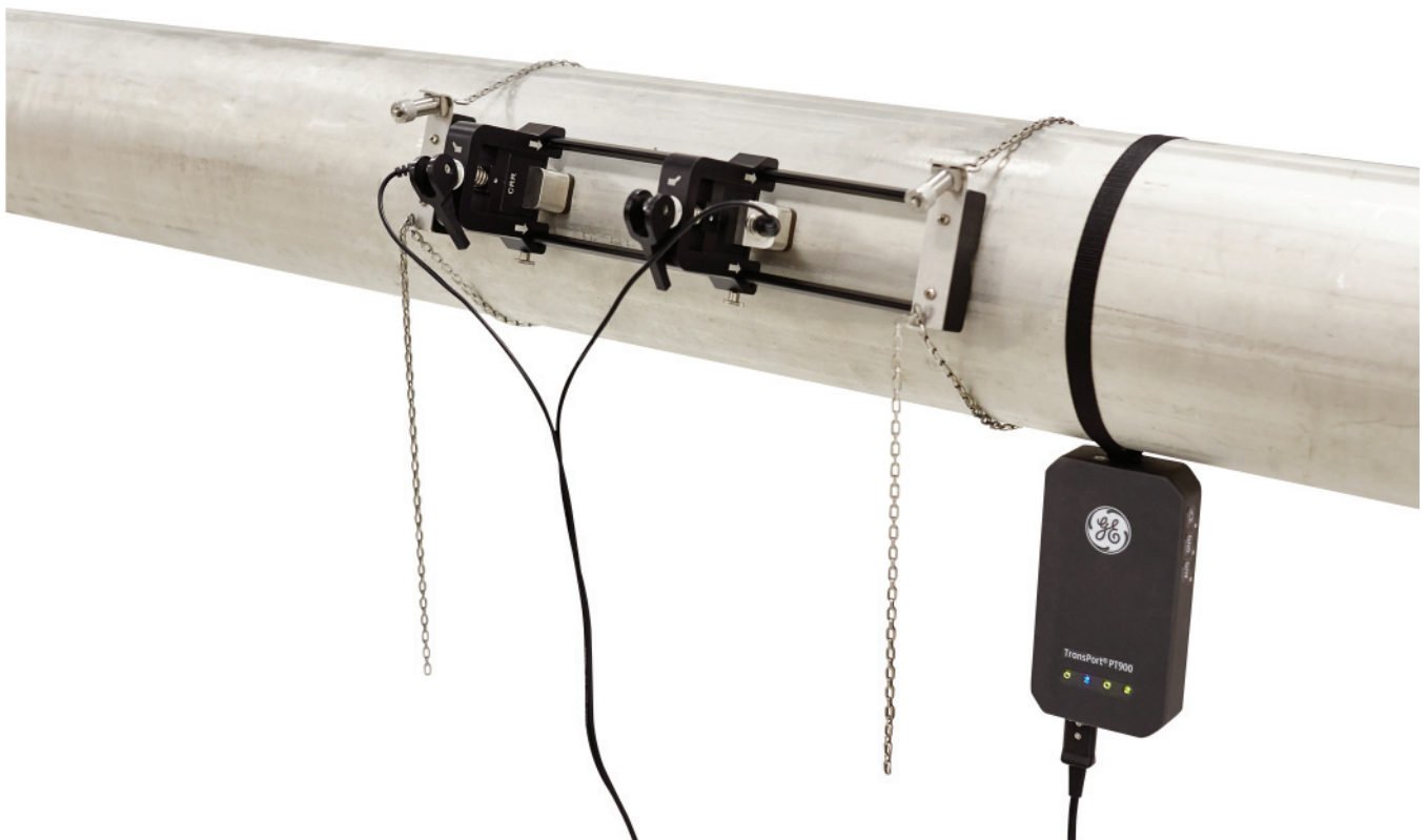
Зажимное устройство, преобразователи и электронный блок, установленный на трубе
