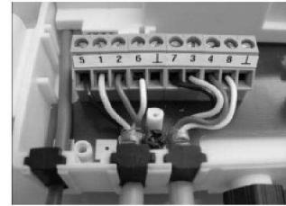
рис. 6 четырехпроводное подключение термодатчиков сопротивления (в случае удлинения термодатчика сопротивления)
