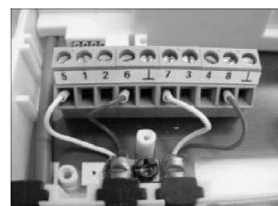
рис. 5 прямое подключение (двухпроводное) термодатчика сопротивления
