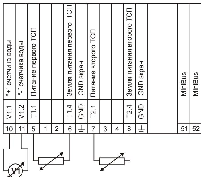
Стандартная схема подключения счетчика воды и ТСП к тепловому чиселителю
