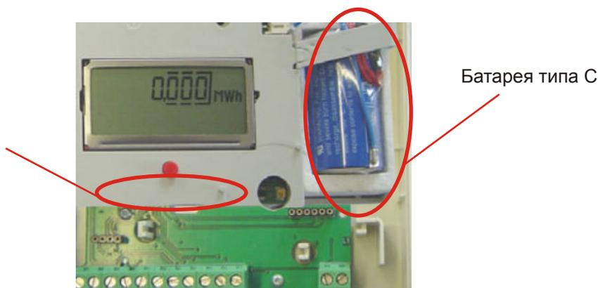
Также возможно питание тепловычислителя от сети переменного напряжения 220 В через блок питания. Блок питания располагается вместо батареи типа C справа от электронного блока.
