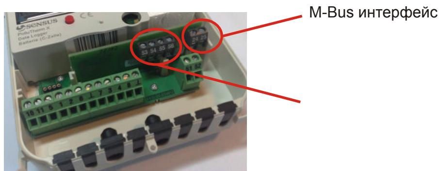
Дополнительные два счетчика подключаются к контактам модуля 53-54 и 55-56, соответственно.
