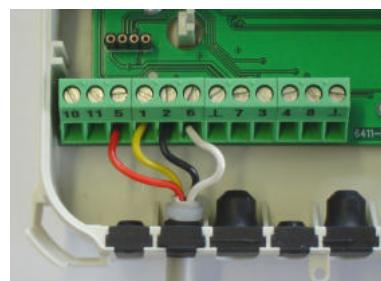
Четырехпроводное подключение термометров
