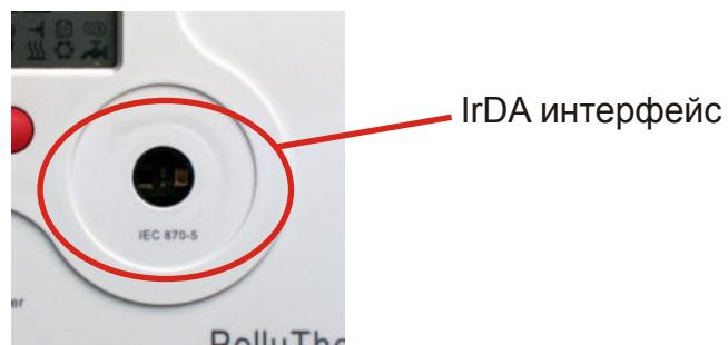
Оптический IrDA интерфейс активизируется кратким нажатием кнопки и находится в этот состояния в течение 1 часа.
