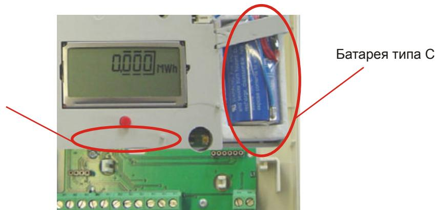
Также возможно питание тепловычислителя от сети переменного напряжения 220 В через блок питания. Блок питания располагается вместо батареи типа С справа от электронного блока.
