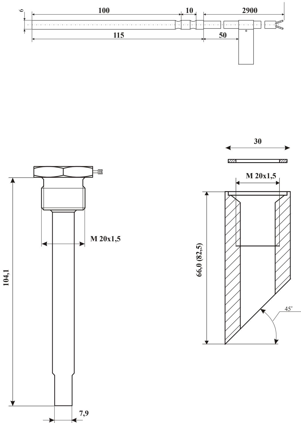
Габаритные размеры термометров сопротивления,
