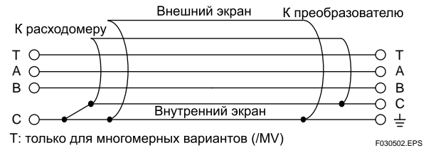
Рисунок 3.4 Устройство сигнального кабеля разнесенного типа
