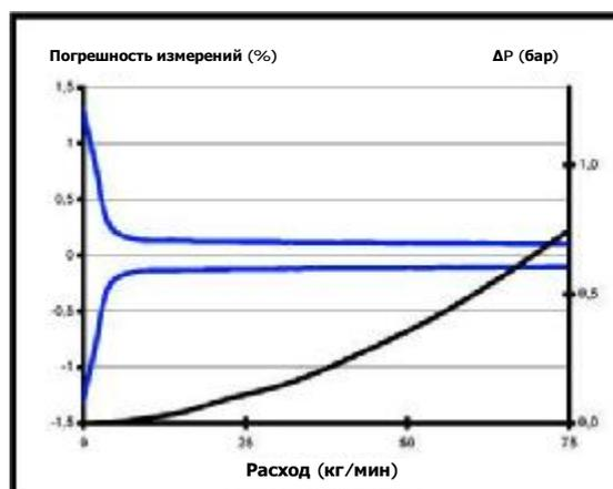
Для последовательной (одиночная труба/ветвь) конструкции для санитарных систем  $Q_{max}$  - 50 кг/мин (50 %)
