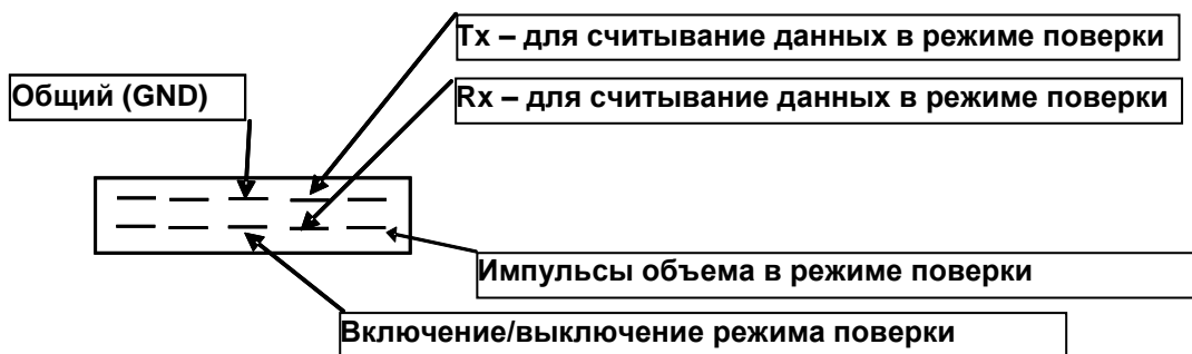
Рис.6.3. Назначение контактов разъема J
