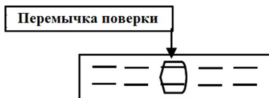
Для выключения режима поверки - снять перемычку поверки.
