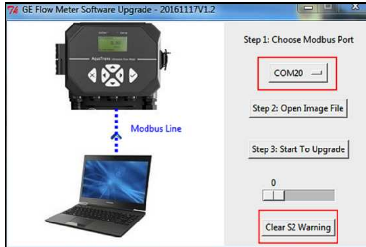
Рис. 39. Очистка предупреждения S2
