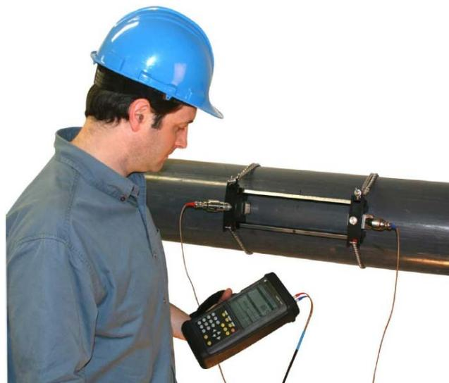
Для обеспечения контакта накладных УЗ преобразователей с трубой доступны различные зажимные приспособления для разных труб и размеров УЗ преобразователей. Эти зажимные приспособления реализуют различные способы крепления к трубе, включая цепи, металлические ленты, ленты Velcro® и магнитные зажимы.
