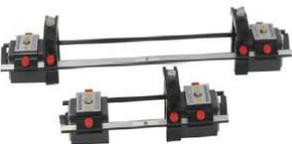
Для крепления УЗ преобразователей на трубе имеется ряд зажимных приспособлений. Для труб размером до 2-х дюймов УЗ преобразователи интегрируются в небольшую трубу. Для труб большего размера до 24 дюймов поставляются УЗ преобразователи с зажимными приспособлениями. Для труб размером до 48 дюймов доступны зажимные приспособления, крепящиеся с помощью цепей. Если все трубы выполнены из углеродистой стали, то для быстрой установки УЗ преобразователей лучшим решением могут быть магнитные зажимы.
