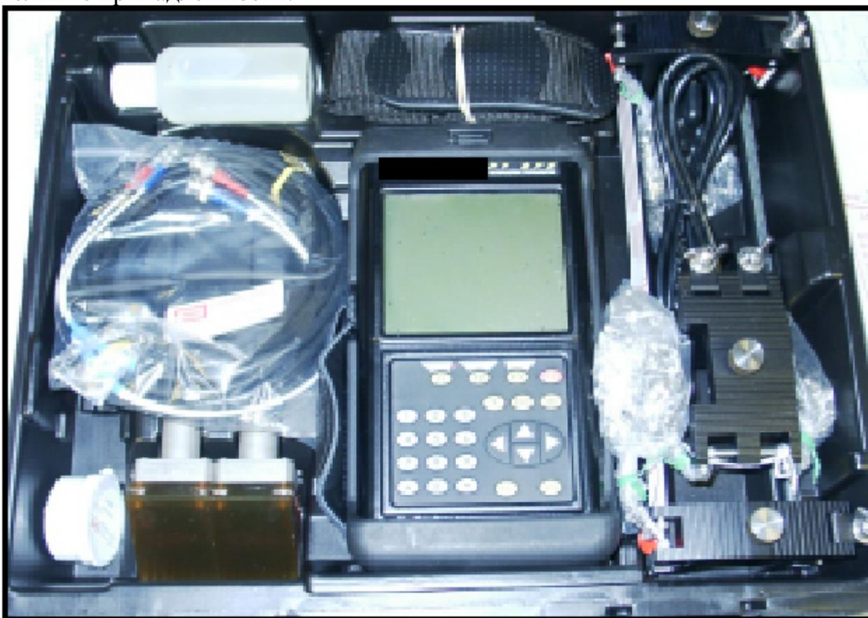
**Рис. 2-1: Расходомер RT878 и дополнительные принадлежности**
