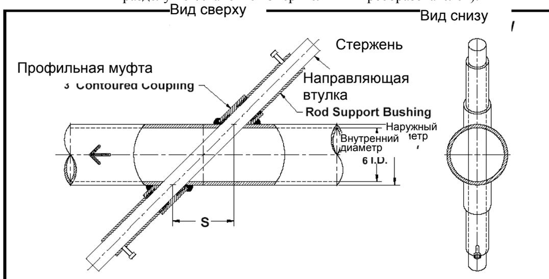
Рис. 7. Размещение преобразователей методом холодной врезки (только для одноходовой структуры):
