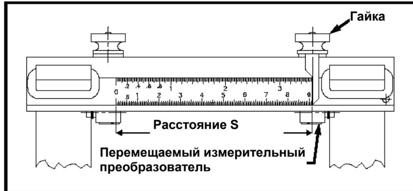
Рис. 40. Крепежное приспособление для небольших труб с перемещаемым измерительным преобразователем
