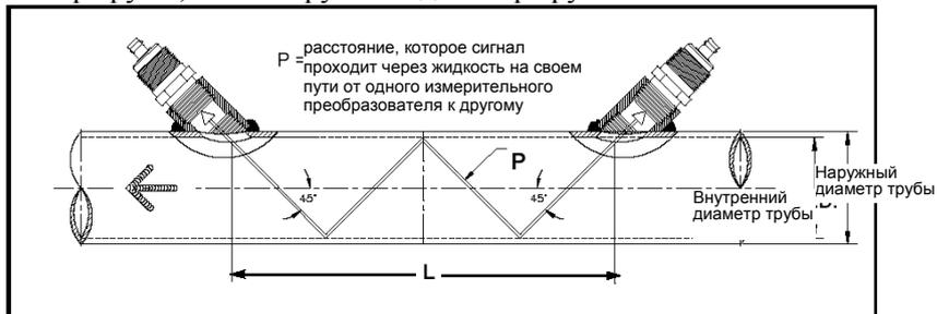
**Рис. 3 Многоходовая измерительная ячейка (четыре хода):**
