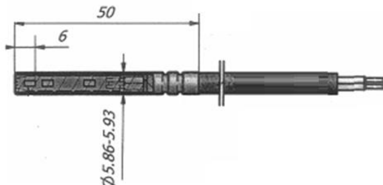
Рис. В3.2. Габаритные размеры датчиков температуры типа PL
